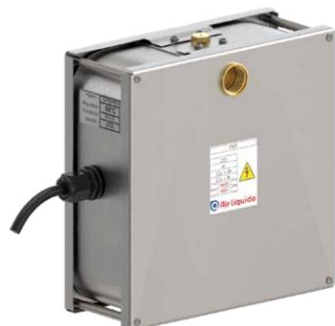
Le modèle GHT est un réchauffeur de gaz de grande capacité pour une utilisation dans des installations d'approvisionnement en gaz centrales. Il mesure près de 220 mm de long, raccord de bouteille compris. Son poids est d'environ 2,3 kg. En fonction du modèle, la livraison comprend les éléments de raccordement correspondants, à savoir les câbles et les prises.
