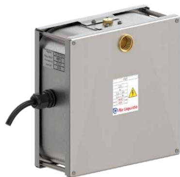
GHT è un preriscaldatore per gas con una grande potenza per l'uso negli impianti di distribuzione dei gas centralizzati. Presenta una lunghezza di ca. 220 mm incluso l'attacco della bombola. Ha un peso di circa 2,3 kg. A seconda del modello viene fornito con gli elementi di collegamento corrispondenti, ovvero cavi e connettori.
