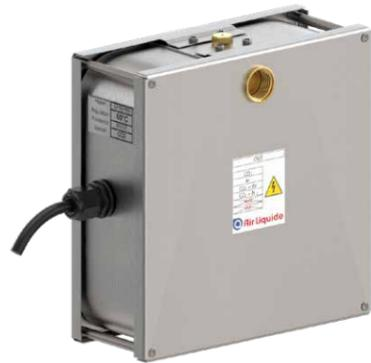
Der GHT ist ein Gasvorwärmer mit grosser Leistung für den Einsatz bei zentralen Gasversorgungsanlagen. Er hat inklusive dem Flaschenanschluss eine Baulänge von ca. 220 mm. Sein Gewicht beträgt etwa 2,3 kg. Die Lieferung erfolgt je nach Ausführung mit den entsprechenden Verbindungselementen Kabel und Stecker.
