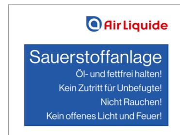
Mit den Warnschildern wird in Gaselägern auf die Gefahr und Verbote für bestimmte Gasarten hingewiesen. Das Warnschild kann entweder aufgeklebt oder direkt auf die Wand geschraubt werden.
