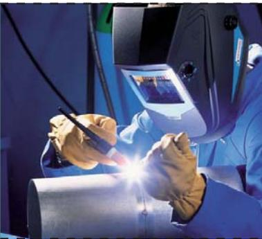
Das Formieren bildet bei Qualitätsschweissarbeiten, wie z.B. bei der Fertigung von hochlegierten korrosionsbeständigen Komponenten, eine notwendige Massnahme für die Qualitätssicherung und Wirtschaftlichkeit.
