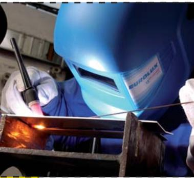
Wurzelschutzgase erhalten bei der schweisstechnischen Verarbeitung von Metallen weitgehend deren Eigenschaften wie Korrosionsbeständigkeit und Festigkeit.
