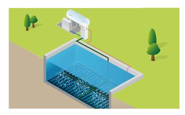
Der INJECTOR-POROXAL arbeitet ohne externe Energieversorgung. Da der INJECTOR-POROXAL nicht aktiv durchmischt, ist bei alleiniger Nutzung ein zusätzliches Rührwerk zur Durchmischung des Beckens erforderlich.
