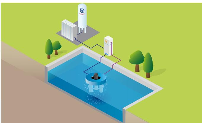
**L'INJECTEUR D'OXYGÈNE POROXAL** repose sur l'utilisation de diffuseurs tubulaires développés tout spécialement pour l'injection d'oxygène. Il fonctionne en toute autonomie d'un point de vue énergétique et a été optimisé pour les bassins à boues activées profonds. Parallèlement à l'utilisation d'oxygène ( $O_2$ ), il est possible d'avoir également recours au dioxyde de carbone ( $CO_2$ ) pour ajuster la valeur du pH.
