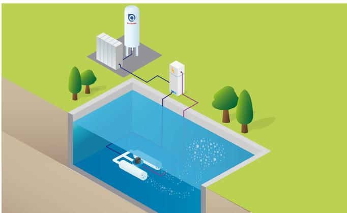
**L'INJECTEUR D'OXYGÈNE TURBOXAL** est un système d'injection à turbines flottant, optimisé pour les lagunes ou les bassins à boues activées généralement peu profonds.
