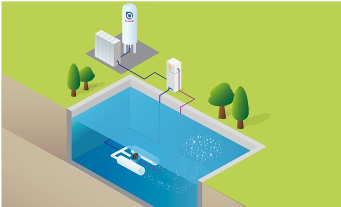
Der **OXY INJECTOR-TURBOXAL** ist ein schwimmendes Turbinen-Eintragungssystem, optimiert für flache Belebungsbecken oder Lagunen.
