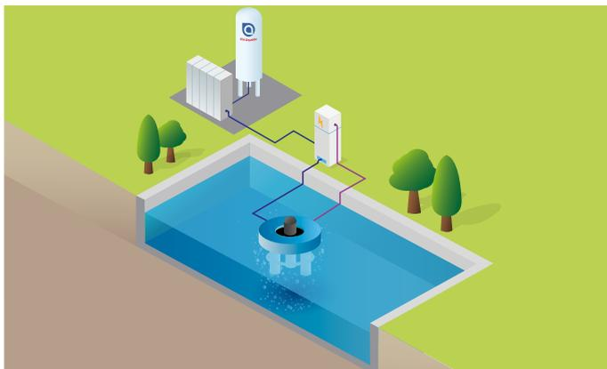
Der **INJECTOR-POROXAL** basiert auf der Nutzung von speziell für Sauerstoff entwickelten Schlauchausströmern zu Sauerstoff-Injektion. Er arbeitet energieautark und ist für tiefere Belebungsbecken optimiert. Neben der Nutzung von  $O_2$  kann ebenfalls  $CO_2$  zur pH-Wert-Einstellung genutzt werden.
