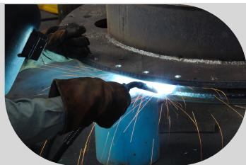
ARCAL™, la solution de Carbagas pour gaz de protection en soudage à l'arc
